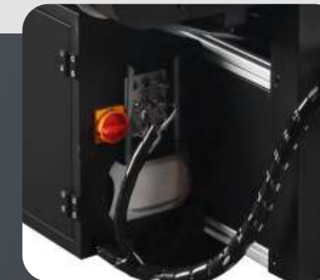
Conexão e entrada de energia
